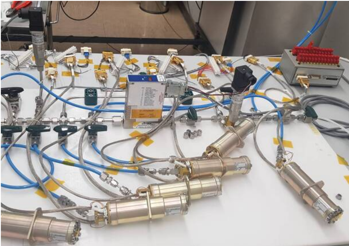
I micro-pulsori realizzati da Leonardo per la missione Euclid
