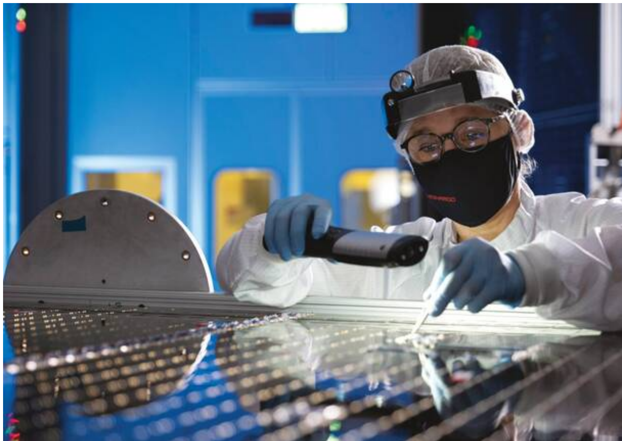
I pannelli fotovoltaici realizzati da Leonardo per la missione Euclid
